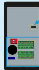
**Micro USB:** Para configuración y actualización de firmware
